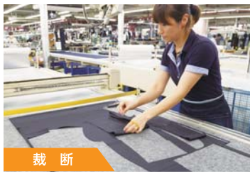
裁断 生地はレーザー裁断機で自動裁断。その後、各部品は搬送ハンガーで自動的に流れていく。
