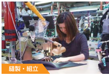
縫製・組立 加工指図に基づいて、縫製ステーションで加工。徐々にスーツの形状に組み立てられていく。
